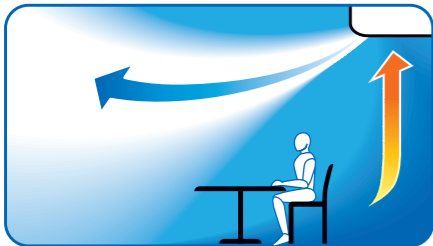
Bei Deckengeräten lässt sich der Luftstrom mittels Luftleitlamellen so einstellen, dass er über die Personen hinwegführt.
